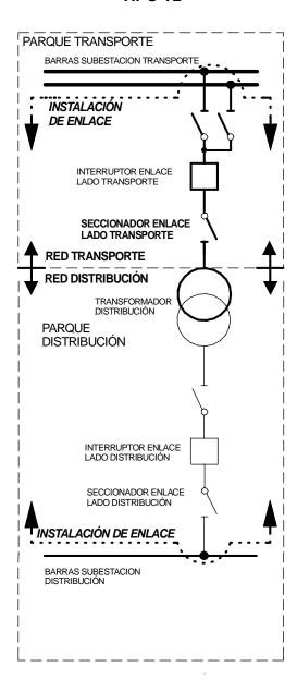
Para mayor aclaración de la frontera entre transporte y no transporte para subestaciones de transporte con configuraciones diferentes a la doble barra ilustrada en los diagramas anteriores, se representa a continuación, también a modo de ejemplo, diagrama en el que se señala el punto frontera para los casos en los que la subestación de transporte tenga una configuración de interruptor y medio.
